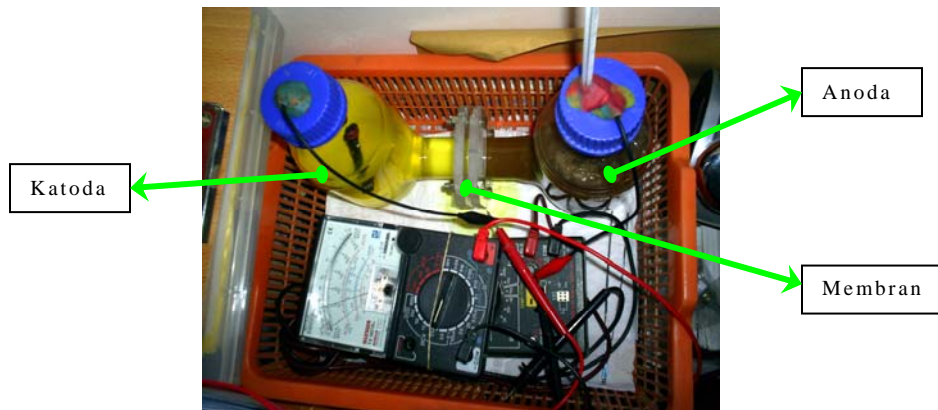
Gambar 3.1 Sistem MFC dengan bejana sepasang
